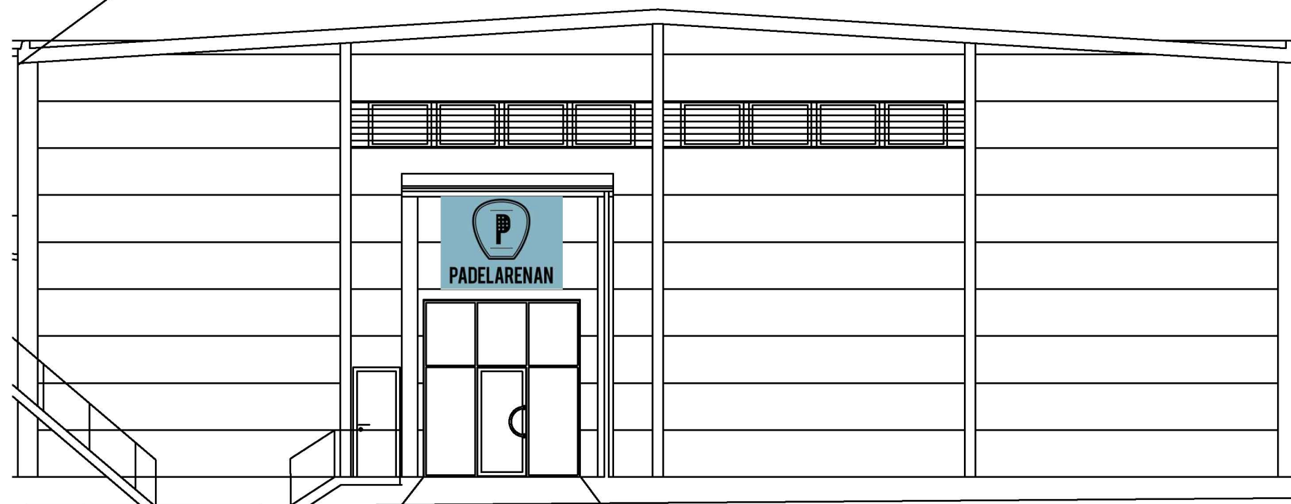
Nytt Entréparti i befintlig Portomslutning
