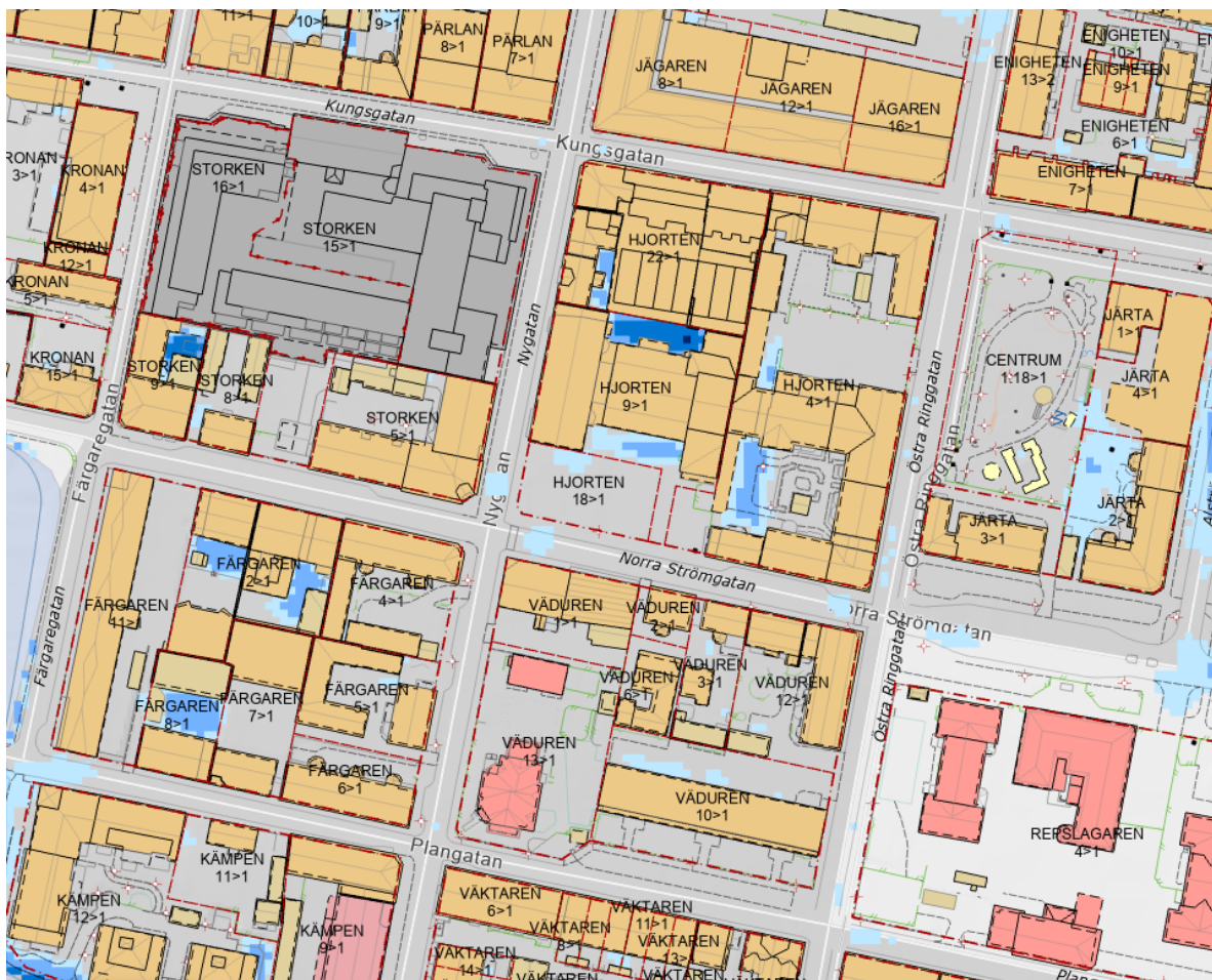
Figur 17. Urklipp från kommunens skyfallskartering som visar maxdjup vid 100-årsregn med klimatkoefficient 1.35. Det ljusast blåa indikerar en vattenmängd på 10-20 cm.
