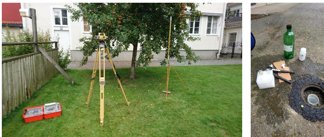
Figur 8. Vänster: Inmätning med totalstation. Höger: Provtagning av grundvatten i Hj4.
