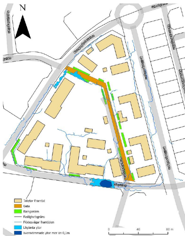
Föreslagna placeringar för biofilteranläggningar, regngården.
