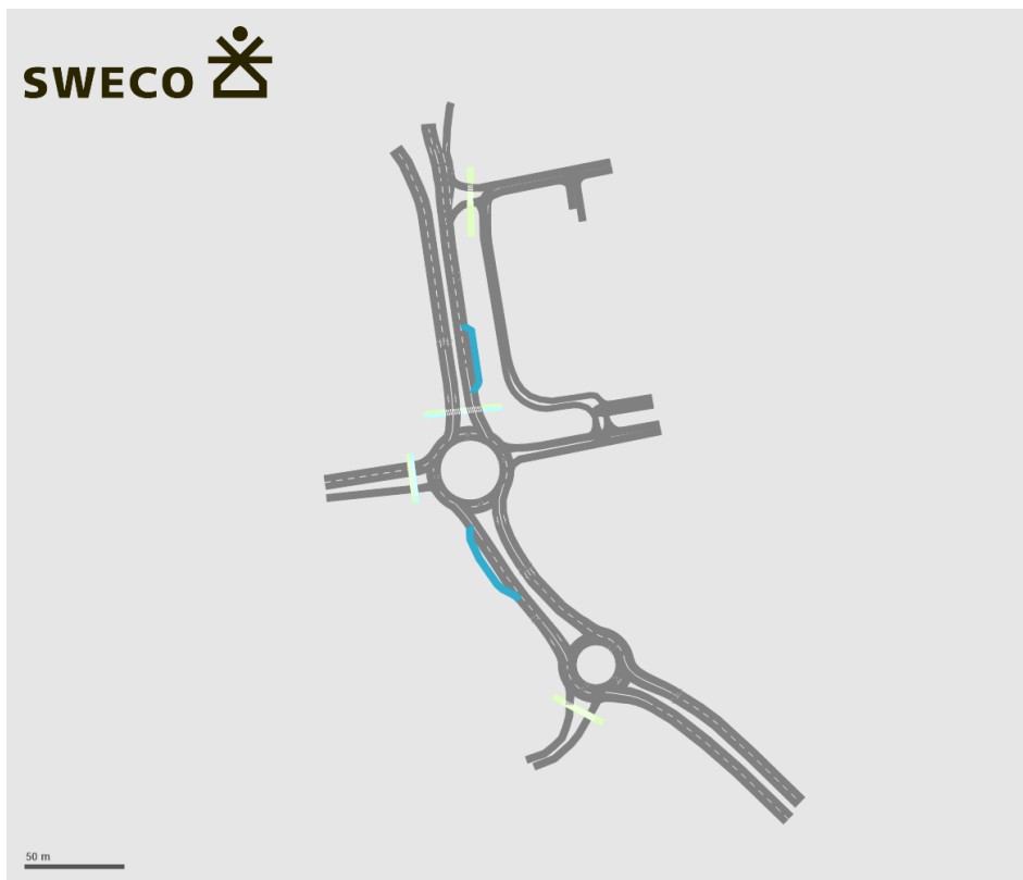
Figur 17: Simuleringsmodellens utbredning samt indelning. Grå - gator för blandtrafik, Mörkare blå - gator för busstrafik, Ljus grön/blå - gator för gång och cykel.
