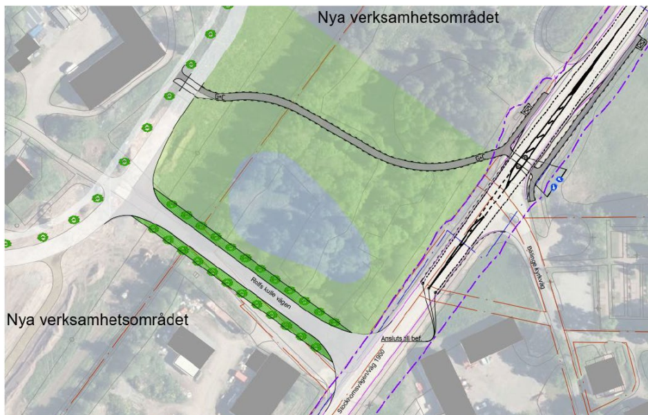
Figur 7. Föreslagen utformning av Rolfs Kullevägen, gång- och cykelväg med tillhörande passage över väg 1900 samt upprustade hållplatser.
