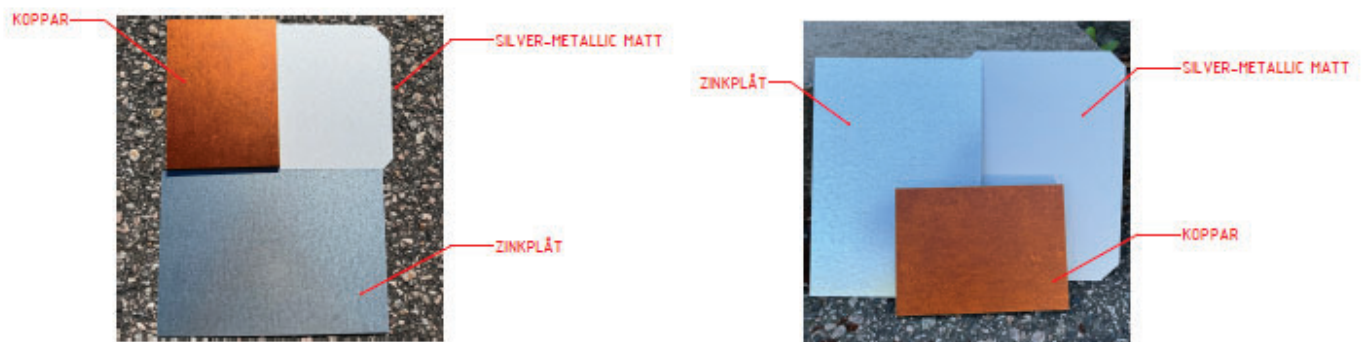
Test av fasadmaterial i solljus respektive molnigt väder
