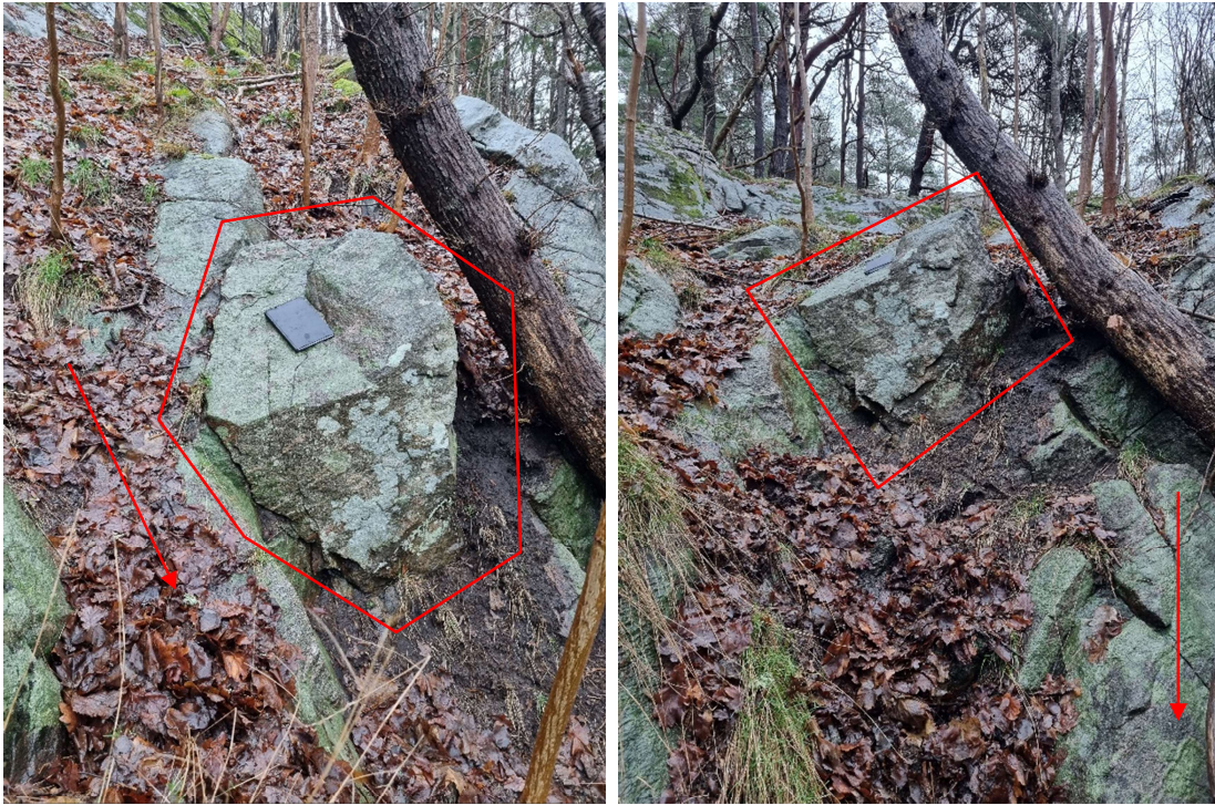
Figur 4. Bergslänt med risk för blockutfall i område 3. Vänster: fotat mot söder. Höger: fotat mot öst. Pilar visar riktning neråt i slänten.
