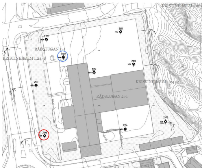
Figur 8 Urklipp placering av geoteknisk och hydrologisk undersökning (Sweco, Markteknisk undersökningsrapport /Geoteknik, MUR, Detaljplan för Rådstugan 2, Alingsås 2021-03-12). Röd och blå ring markerar placering av grundvattenrör.
