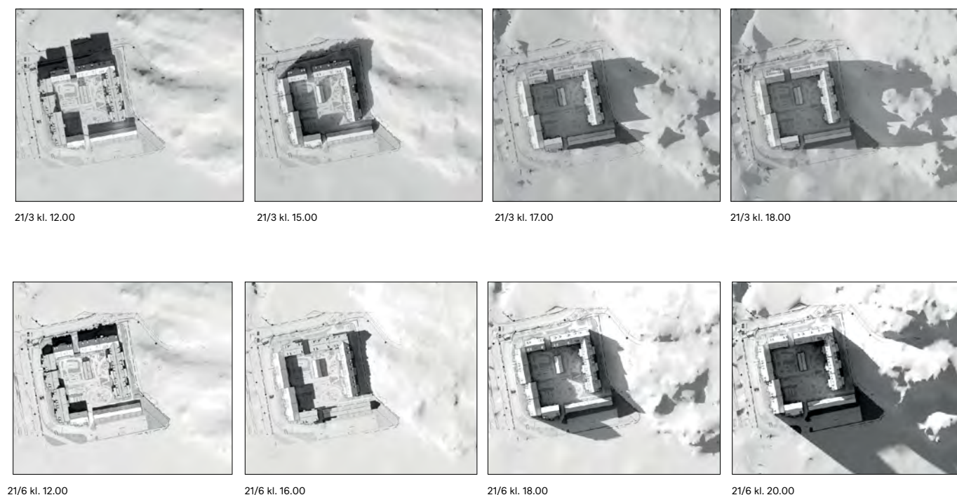
Figur 23 - Solstudie som är genomförd med huvudsyfte att redovisa skuggbildning över Hjortmarka naturreservat öster om planområdet (Krook&Tjäder, 2023-01-19)
