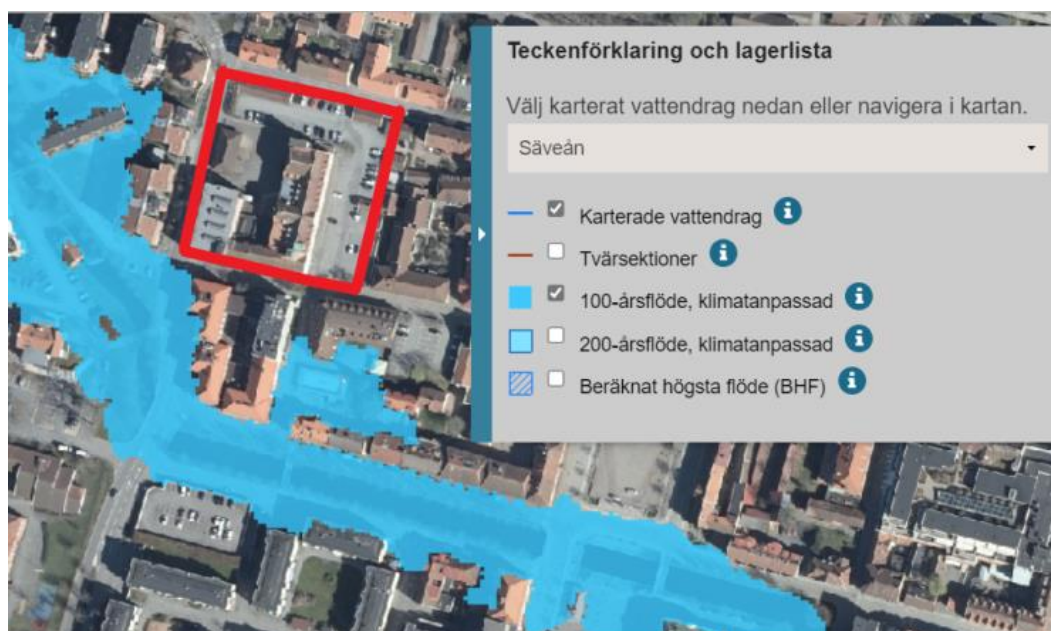
Figur 8 Fastigheten Solen 14 och vattenutbredning 100 års flöde i Forsån (Källa; MSB)
