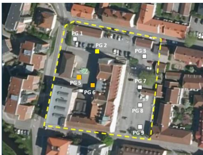
Figur 2 Provgropar i samband med markundersökning
