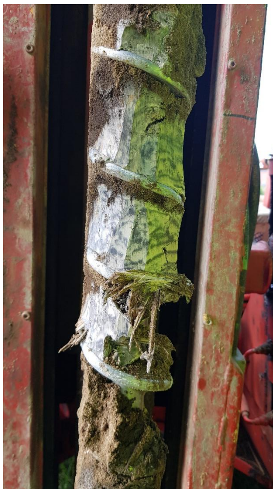
Figur 6. Skikt på 0,5-0,8 m i CWM5 där höga halter barium, kobolt och krom påvisades.
