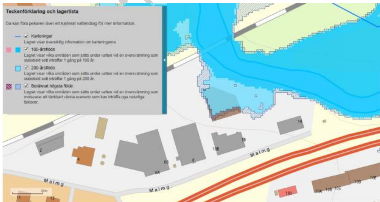
Figur 2 Sävåns placering samt dess utbredning vid översvämning som har olika sannolikheter att inträffa. Denna bild visar befintlig byggnad och ej planerad nybyggnad.
