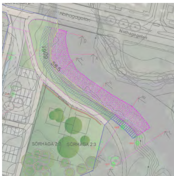
Avschaktning och förstärkt erosionsskydd visad i Sektion A
