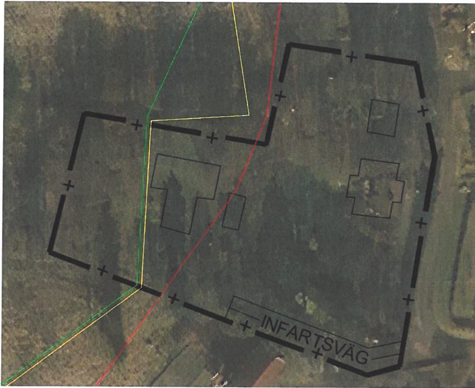
Figur 3: En tolkning hur vattennivån ligger utefter ett 100- & 200 års flöde, samt beräknat högsta flöde (BHF). Röd linje: BHF. Gul linje: 200 års flöde. Grön linje: 100 års flöde.
