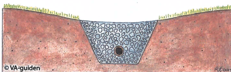
Figur 7.6 Illustration av ett avskärande dike med stenkross och dräneringsledning.
